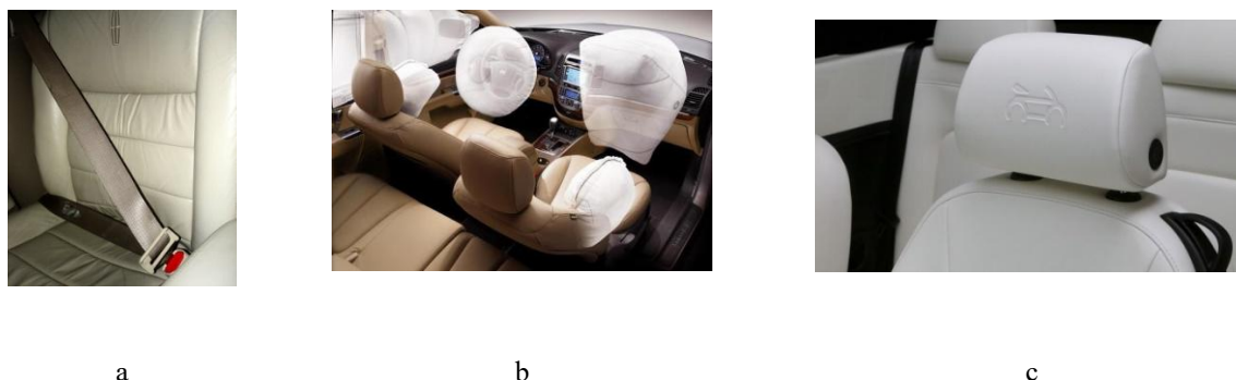
Fig. 2. Elemente ale sistemelor de siguranță pasivă
